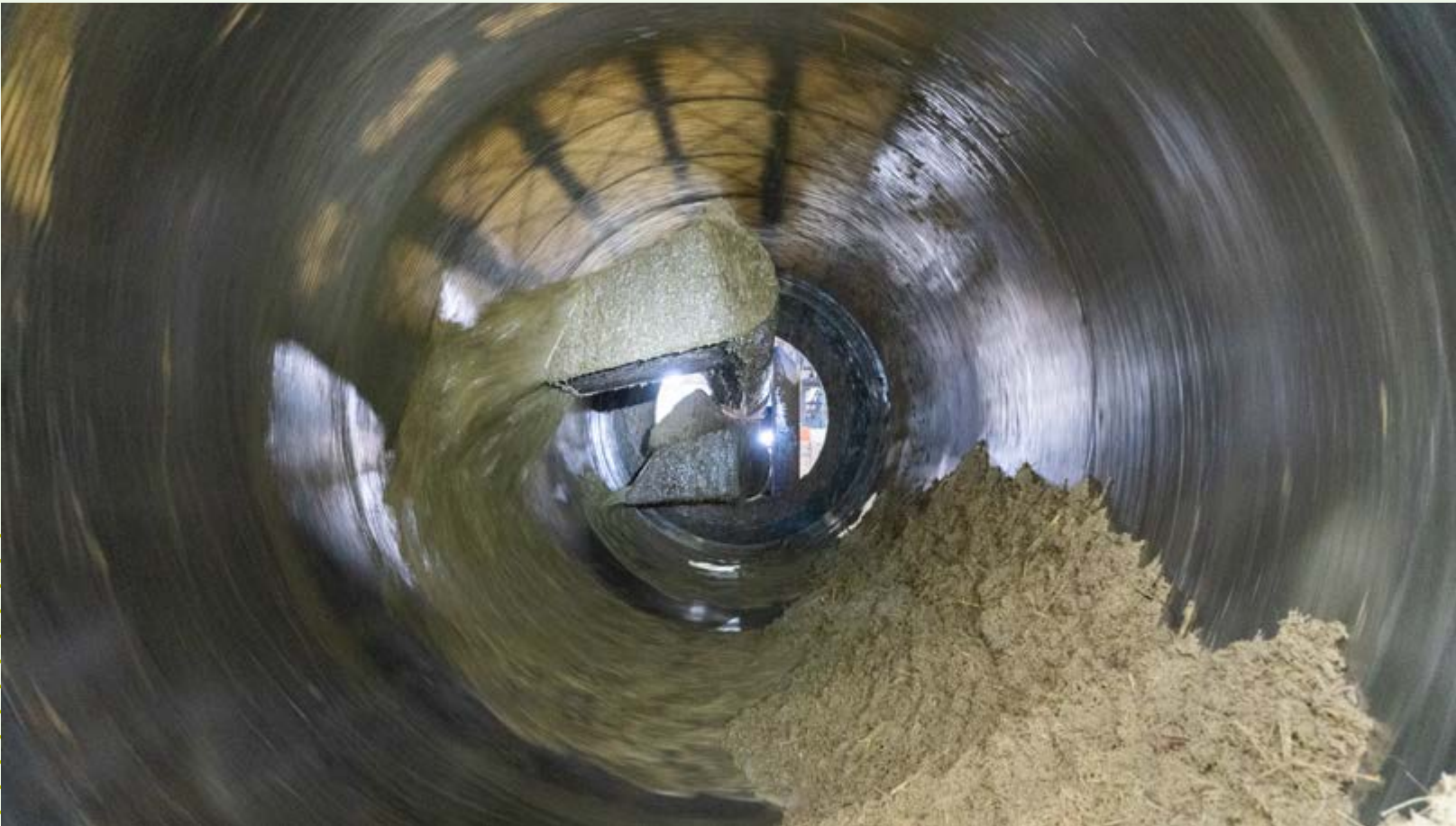
Filtro rotativo Trapiche Farrel.
